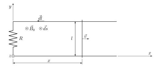
se desliza sobre los lados paralelos, de modo que con su contacto cierra un circuito rectangular de área variable. Para fijar ideas, suponga que la varilla móvil viaja hacia la derecha con velocidad constante  $\vec{v}$ , mientras que el montaje completo se encuentra inmerso en un campo magnético uniforme  $\vec{B}_0$ , perpendicular al plano de la horquilla y saliente del dibujo. El origen de coordenadas, y la terna directa de
