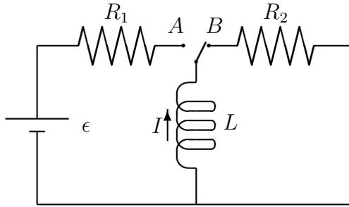
donde el proceso transitorio se inicia al tiempo  $t = 0$ , cuando el conmutador pasa de la posición A a la posición B. La corriente que circula inicialmente por el inductor es la que sostiene la pila y viene dada por
