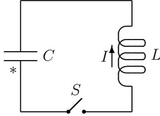
muy simple de este tipo de circuito. El mismo conecta en una malla, un capacitor y un inductor. El capacitor está inicialmente cargado con una carga  $Q_0$ , y el interruptor se acciona al tiempo  $t = 0$ . La relación entre cargas y corrientes sigue siendo compatible con (9). La regla de mallas conduce a
